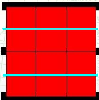
Die Parador GmbH & Co. KG Ladeeinheiten sind formschlüssig quer oder längs zur Fahrtrichtung an die stabil ausgeführten Seitenwände gemäß DIN EN 12642 Code XL und untereinander zu verladen.
